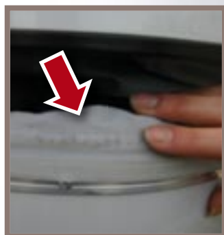
Légère abrasion du tissu causée par l'aplatissement du couvercle sur la base; situation remarquée sur une tente neuve.
